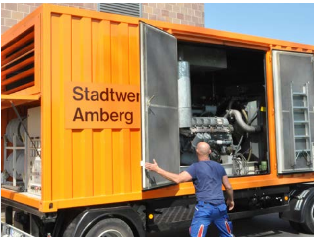
Die Wasserversorgung ist bei den Tiefbrunnen und im Wasserwerk ausgefallen, jetzt wird es für die Verantwortlichen ernst. Nur mit Hilfe von leistungsfähigen Stromaggregaten kann die Wasserversorgung im Amberger Raum im flächendeckenden Blackout-Szenario auch wirklich gewährleistet werden. Foto: KG
